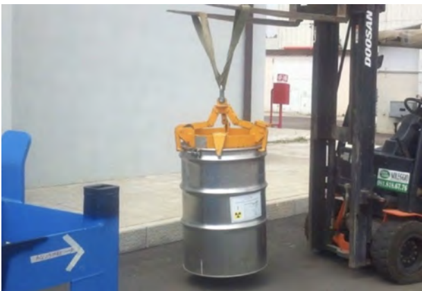
Figura 26: Un fusto da 220 litri contenente rifiuti di basso livello LLW. Il rateo di dose a contatto è di circa 1 \mu\text{Sv/h} [12].
