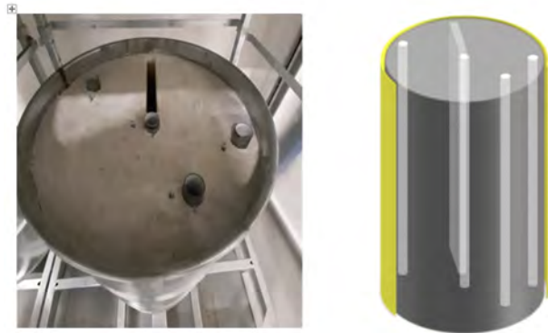
Figura 58: Fusto cementato di test con dei fori verticali per l'inserimento di sorgenti di alta intensità.
