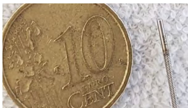
Figura 2: Rapporto dimensionale tra una sorgente di ^{192}\text{Ir} per brachiterapia e una moneta.
