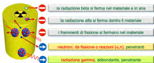
Figura 30: Schema delle emissioni radioattive da un fusto di materiale.
