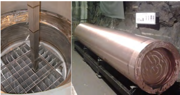
Figura 23: Le barre di spent fuel vengono inserite in speciali contenitori in rame e acciaio detti canister [10].
