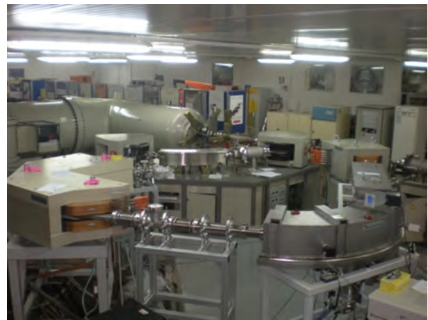
Figura 4: Le due linee per la misura diretta degli isotopi radioattivi. Una è dedicata alla misura del radiocarbonio e la seconda agli altri isotopi, dal ^{10}\text{Be} agli attinidi
