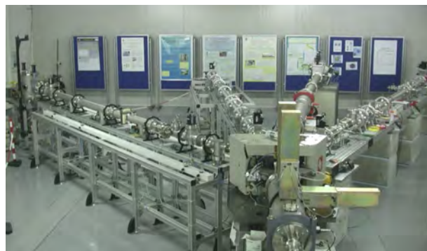
Figura 8: Le line IBA connesse con l'acceleratore Tandetron del CEDAD. Da sinistra: RBS, PIXE-PIGE, II, Microfascio.
