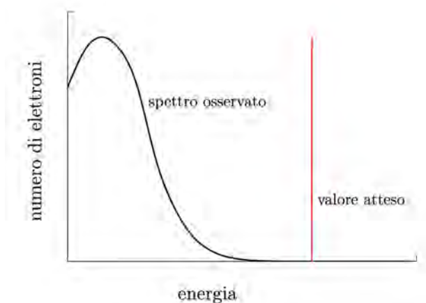
Figura 2: Spettro energetico degli elettroni emessi nel decadimento \beta .
