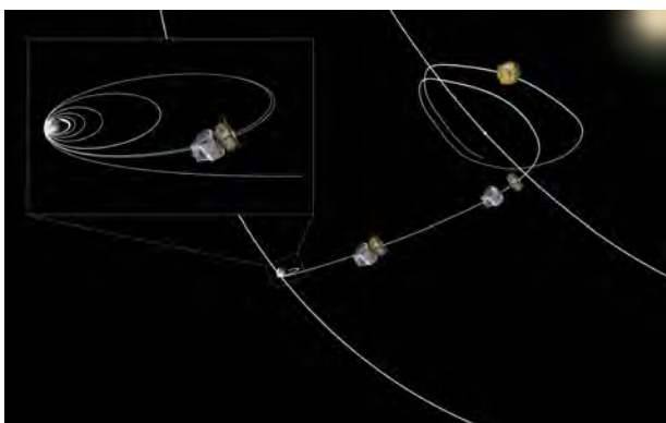
Figura 3: Traiettoria seguita da LPF per raggiungere il punto di Lagrange L1 (credit ESA).
