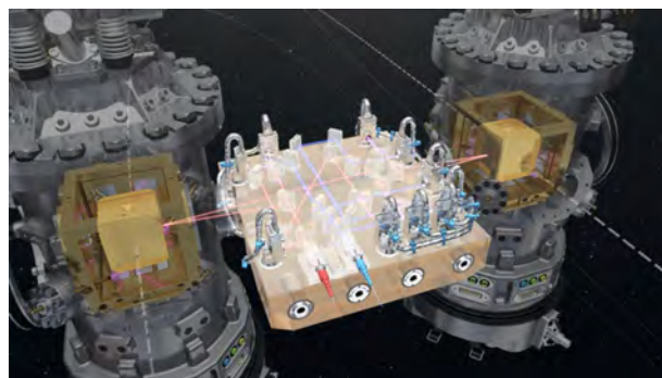
Figura 4: Schema che mostra nell'LPF le due masse di test e in mezzo il banco ottico con il sistema LASER per determinarne la posizione relativa (credit ESA).
