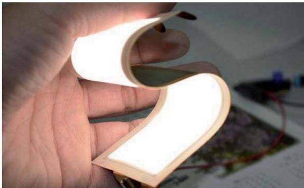
**Figura 1:** In alto, display OLED. In basso, prototipo di OLED bianco flessibile per illuminazione.
